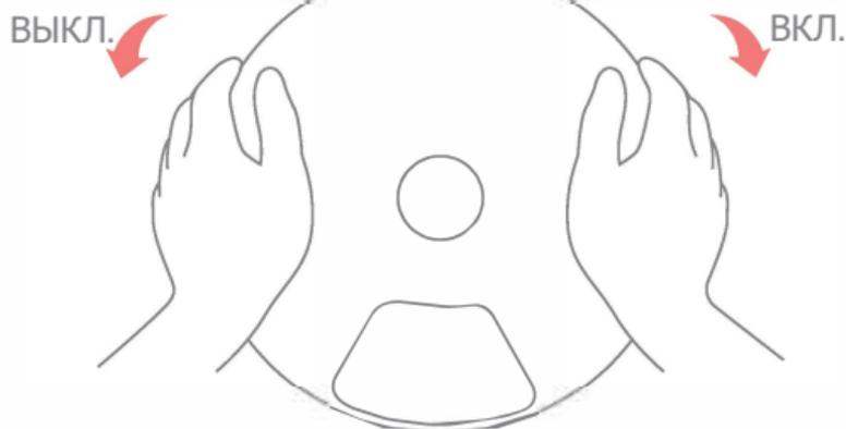
Нажмите на обе стороны верхней крышки и поверните в направлении стрелки, чтобы снять верхнюю крышку.
